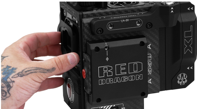
Figure: Instale el Nuevo Módulo OLPF
