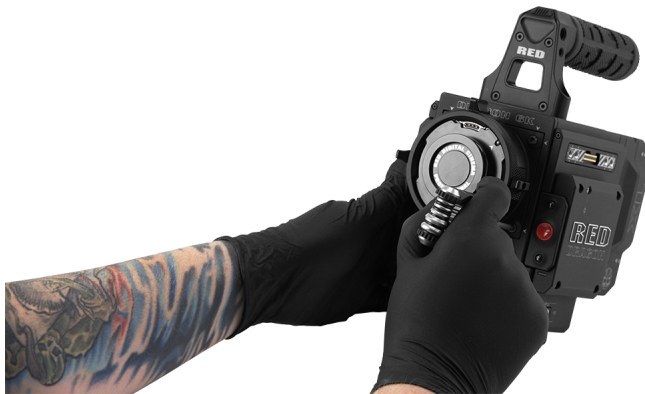
Figure: Apriete los Tornillos
