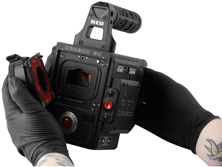
Figure: Retire la Montura de la Lente.
