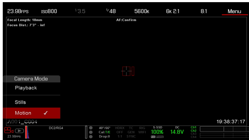
Figure: Deslice hacia arriba para seleccionar un Modo de Cámara
