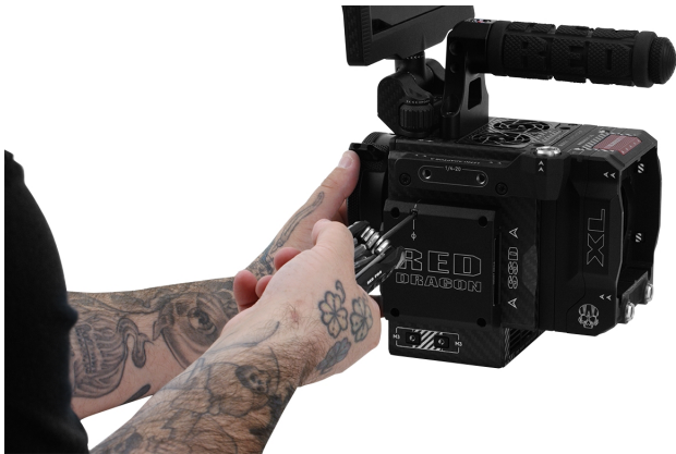
Figure: Quite el Tornillo de Fijación
