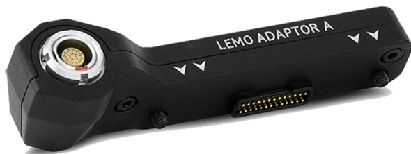
Figure: Adaptador DSMC2 LEMO A
