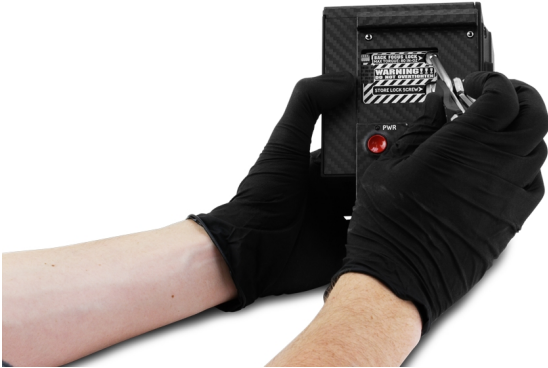
Figure: Seguro del Enfoque Posterior
