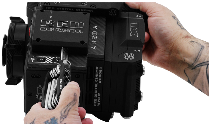
Figure: Retire el Gancho de Enfoque
