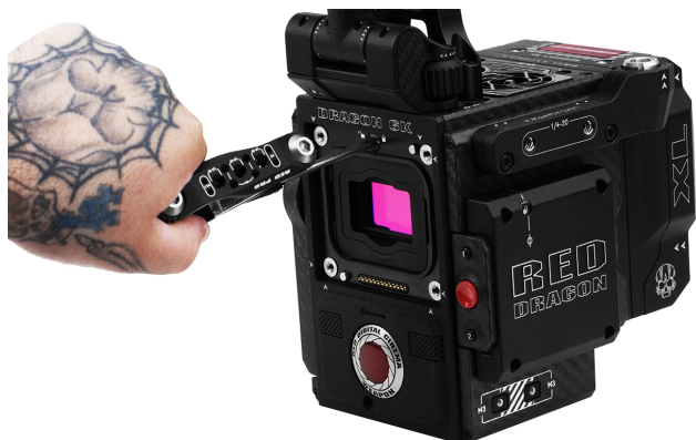
Figure: De Vuelta al Seguro en el Sentido de las Manecillas del Reloj
